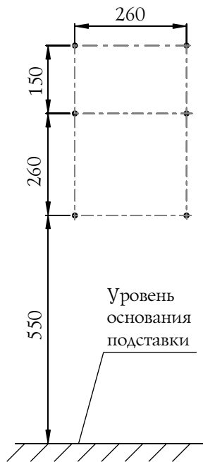
Рисунок 5. Схема отверстий под анкерные болты для крепления подставки.
